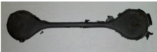
Figura 7 - Corpo de prova de tração apresentando rebarbas devido ao excesso de pressão na cavidade.
