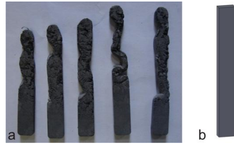
Figura 9 - (a) Corpos de prova de flexão com preenchimento parcial da cavidade; (b) Modelo CAD do corpo de prova de flexão.
