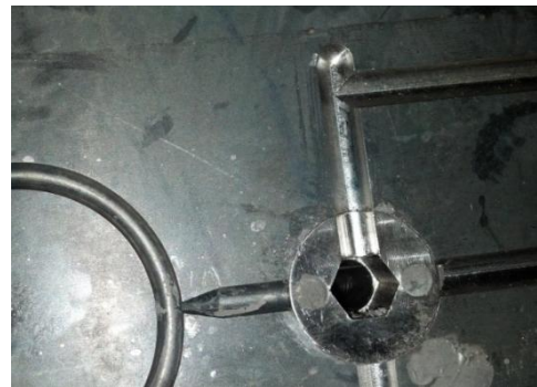
Figura 14 - Bico de injeção (lado fixo) com encaixe para chave Allen.
